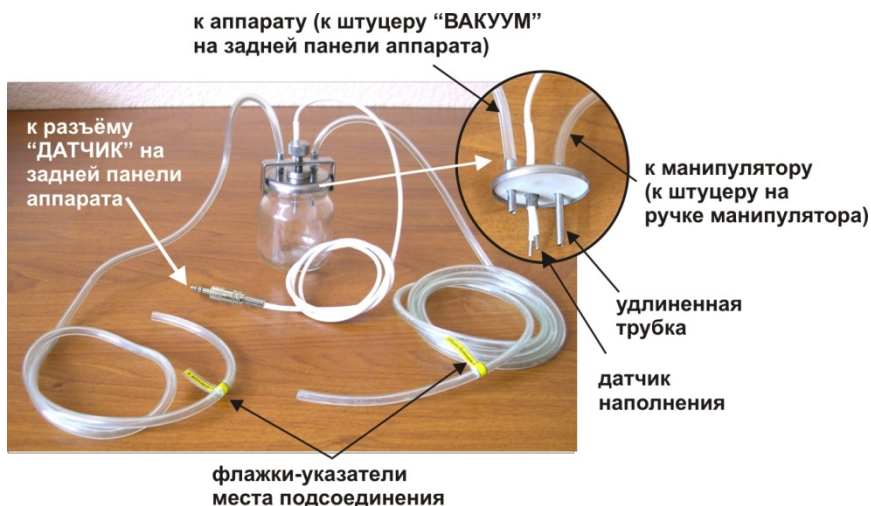
Рис.3. Ёмкость - накопитель блока вакуумного массажа дёсен.
