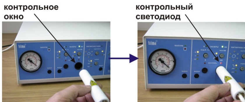
Рис.21. Контроль мощности излучения «инфракрасного» лазера.
